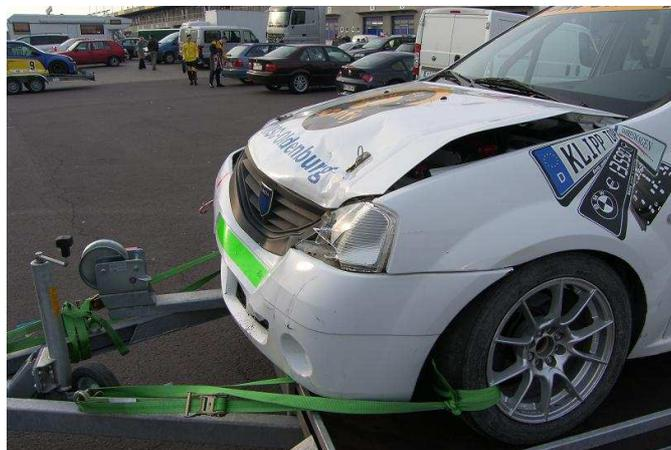
Im Fahrerlager erhärtete sich dann der Verdacht. Ein großes Loch im Kühler. Dies machte ein Weiterfahren unmöglich. Eine genauere Untersuchung zurück in Oldenburg zeigte, dass wir sogar noch Glück gehabt haben, da das Getriebe nur knapp verfehlt wurde. Mittlerweile wurden die Schäden aber behoben und das Auto wird am Nürburgring wieder tadellos da stehen.
