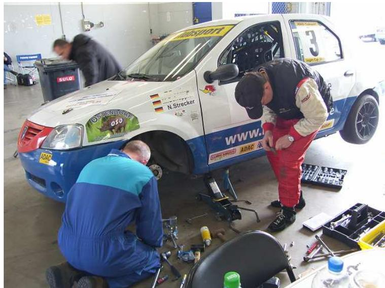
Wiechers war zwar vor Ort, hatte aber für den Dacia keinerlei Ersatzteile mit, so dass wir auf unseren Fundus angewiesen waren. Team 2 hatte noch einen kompletten Achsschenkel einschl. Radnabe und Bremsscheibe, so dass die große Stunde von Cord kam. Innerhalb von einer halben Stunde war die neue Achse fertig, über die Details der Reparatur will ich gar nicht berichten, es waren etliche.
